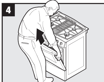
Remove oven door by holding both sides and pulling up./Retirez la porte du four en la tenant par les deux côtés et en la tirant vers le haut./Retire la puerta del horno sosteniendo ambos lados y tirando de ella hacia arriba.
