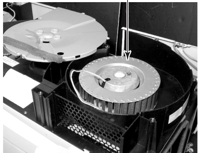
Hood Exhaust Fan Motor
