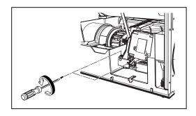
17) Disassemble Air Guide.
