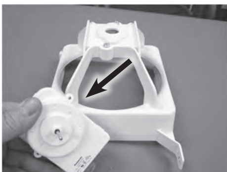
6. Remove fan motor
