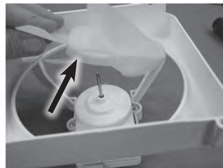
4. Remove fan blade
